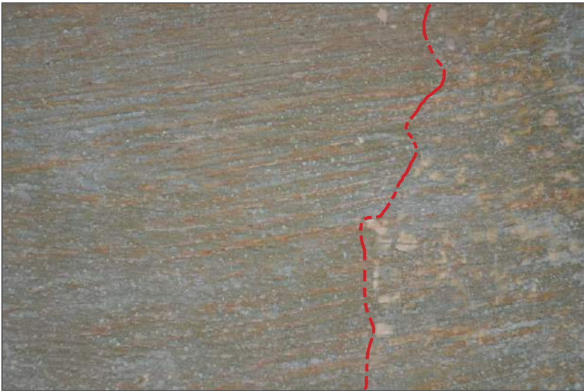
Details van mechanisch vrijleggen naast vrijleggen met oplosmiddelgel Ruth Jongsma
