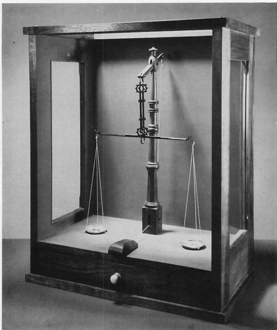
Fig. 86. Reconstructie van een essaieurbalans vervaardigd door Ercker in 1574.
