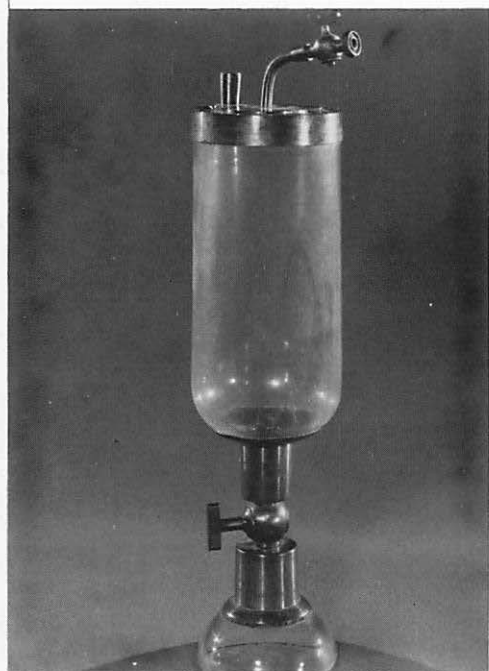
Fig. 74. Ballon met koperen kranen, door Lavoisier gebruikt voor de bestudering van gassen. (Copyright Musée du Conservatoire des arts et métiers, Paris).
