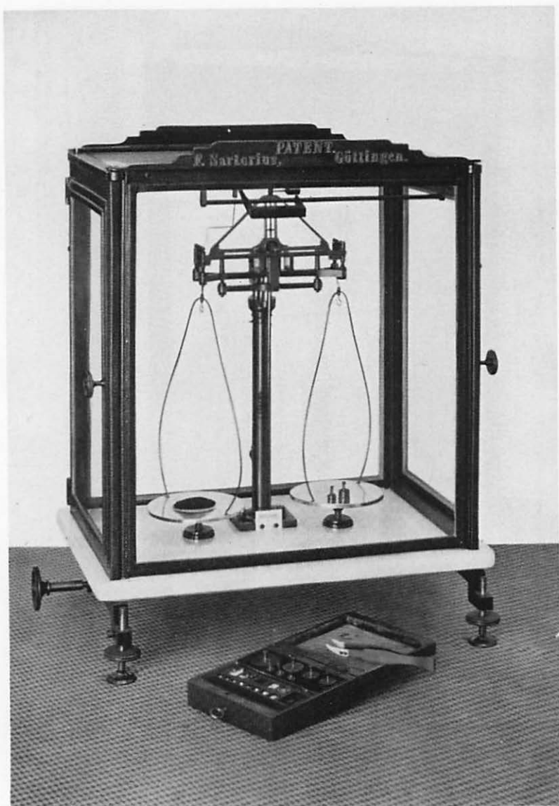
Fig. 90. Analytische balans (1870). Voorganger van de moderne kort-armige Sartorius balans.
