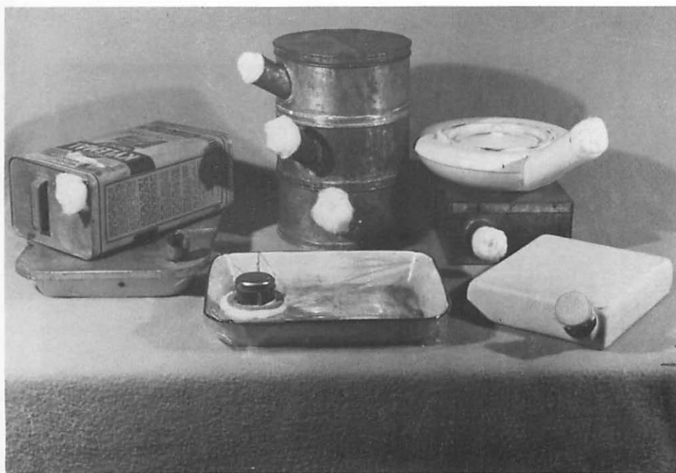
Fig. 79. Blikken en trommeltjes voor penicillinebereiding; met deze apparatuur vervaardigde Chain en Florey in 1940 dit antibioticum.
