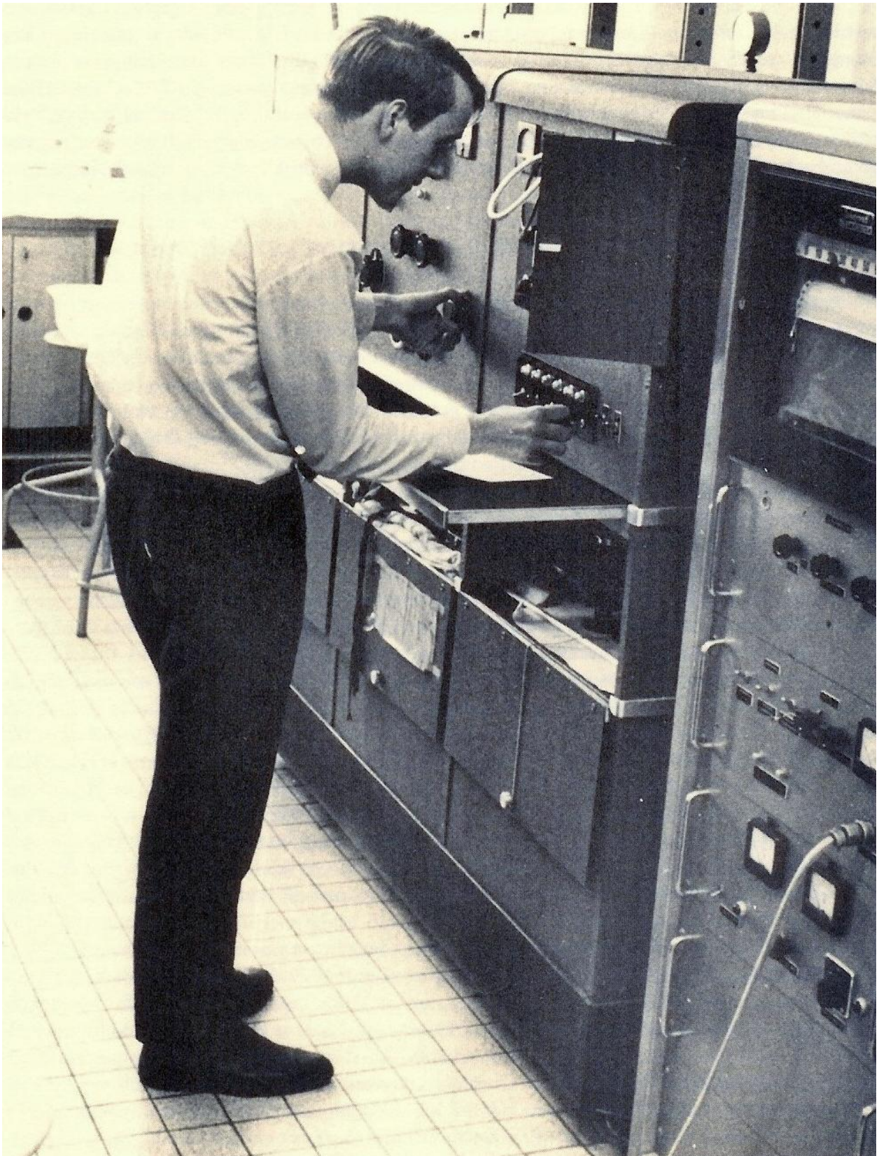
Figuur 7.2: De Spinco Analytische Ultracentrifuge in het tweede Biochemisch Laboratorium in Groningen (1960-1970), met E. Glazenburg, omstreeks 1969. Toen dit apparaat in 1970 verhuisde naar het nieuwe laboratorium in de Paddepoel moest een wand worden opgebroken en was een speciale takelwagen. In de jaren zestig werd de moleculaire massa van bijvoorbeeld eiwitten met zulke analytische ultracentrifuges bepaald. Dat was toen een uiterst tijdrovende aangelegenheid.
