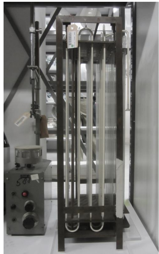
Ionenoptiek van een massaspectrometer en een gepakte gaschromatografische kolom
