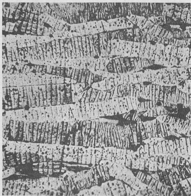
Fig. 2. Gericht Ferroxdure. De kristallen liggen ongeveer horizontaal. De verticale lijntjes geven de verdeling in Weiss-gebiedjes aan. Door de onderlinge beïnvloeding is deze verdeling in vele kristallen doorlopend.
