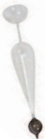
LINKS, De vochtweger van Gabriël Fahrenheit. Afbeelding uit The Philosophical Transactions of the Royal Society of London , n° 384, 1724.
