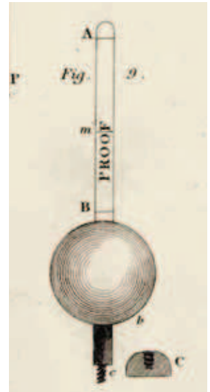
De hydrometer van Clarke. Afbeelding uit The Philosophical Transactions of the Royal Society of London , n° 413, 1730.
