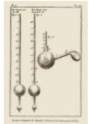
BOVEN, De hydrometer van Dicas. Collectie Nationaal Jenevermuseum, Schiedam.
