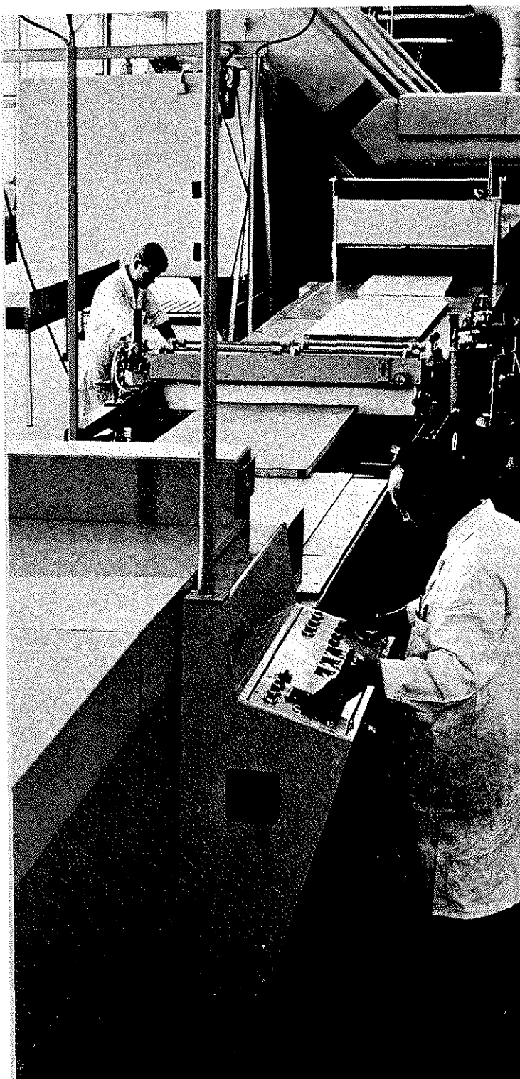
De lakstraat met lakgordijnmachine en droogtunnels op het Sikkens Voorlichtingslaboratorium.
